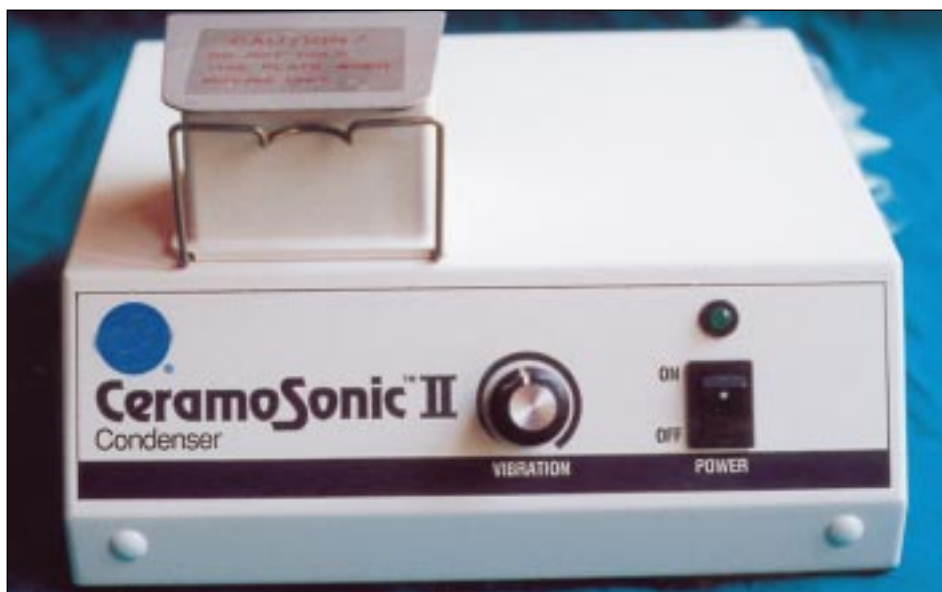
Εικ. 8.13: Συσκευή δόνησης της πορσελάνης.
