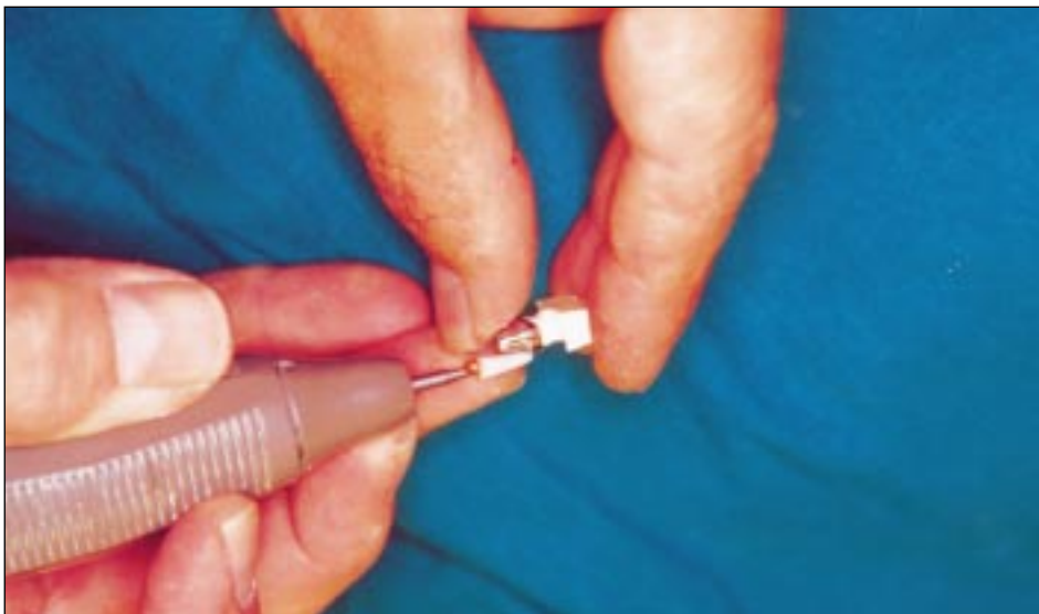
Εικ. 8.5: Τροχισμός του μεταλλικού σκελετού με τροχόλιθο οξειδίων του αλουμινίου.
