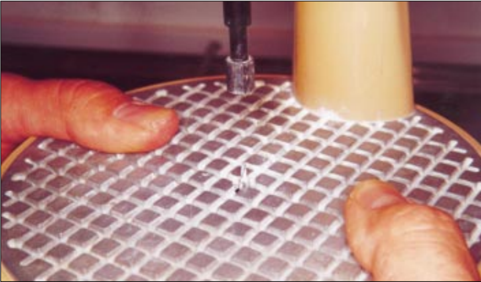
Εικ. 5.6: Στο κέντρο του τραπεζιδίου της συσκευής Pindex υπάρχει μια οπή από όπου διέρχεται το τύμπανο.
