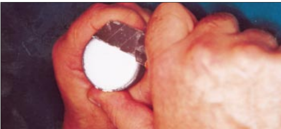
Εικ. 7.1: Μ' ένα νυστέρι αφαιρούμε την επιφανειακή κρούστα από την άνω πλευρά του δακτυλίου.
