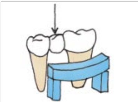
Εικ. 4.6: Όταν μια γέφυρα 3 στοιχείων δέχεται μια δύναμη F , τότε αυτή παραμορφώνεται ελαστικά (λνγίζει).
