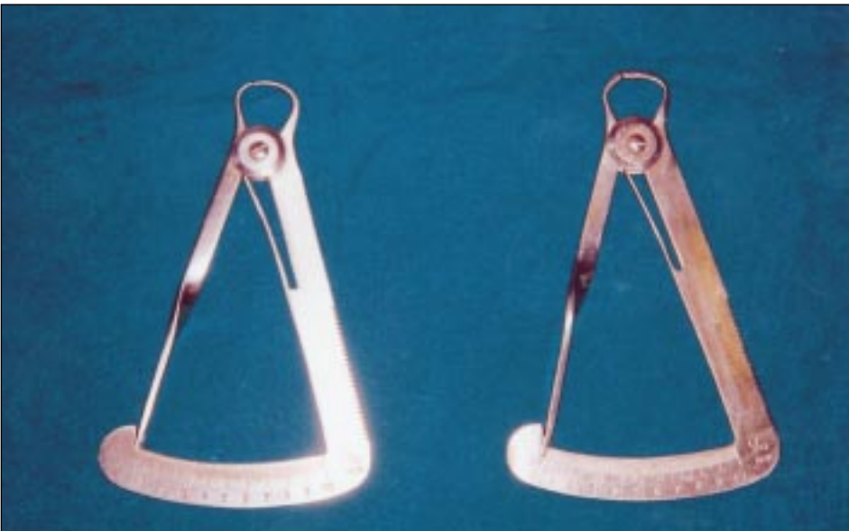
Εικ. 8.4: Παχύμετρα για τη μέτρηση του πάχους.
